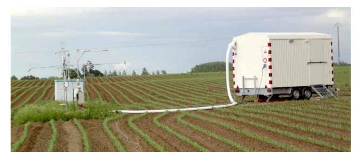
Setup de mesures de flux par eddy covariance au milieu d'un champ de maïs à Lonzée
